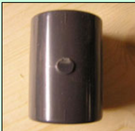
Der Gießansatz auf dem Rohr ist ein guter Ansatz zum Bohren.
