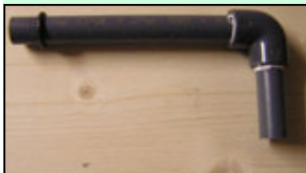
Einen O-Ring auf das Rohr rollen...
